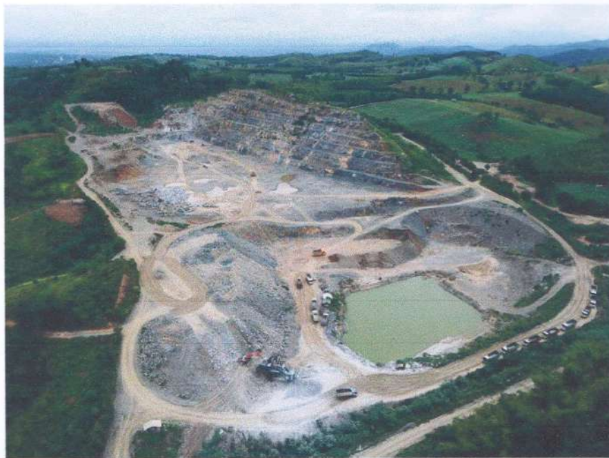
รูปที่ 8 แสดงสภาพพื้นที่หน้าเหมืองบริเวณตอนกลางประทานบัตร มีการทำเหมืองเป็นแบบชันบันได ภาพนี้มองไปทางทิศตะวันออกเฉียงเหนือ
